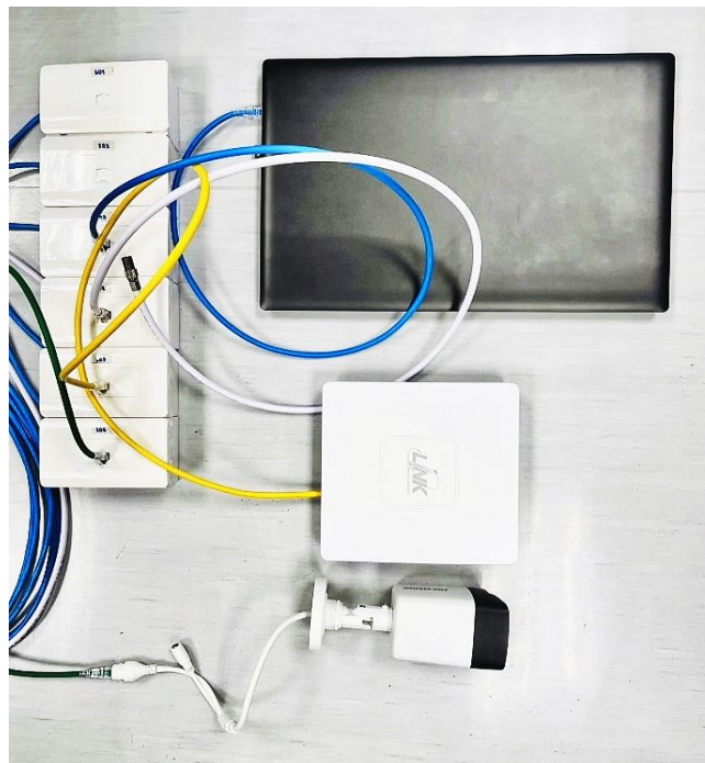
รูปที่ 8 และ 9 แสดงตัวอย่างการ Label และการเชื่อมต่อที่ EQUIPMENT OUTLET
