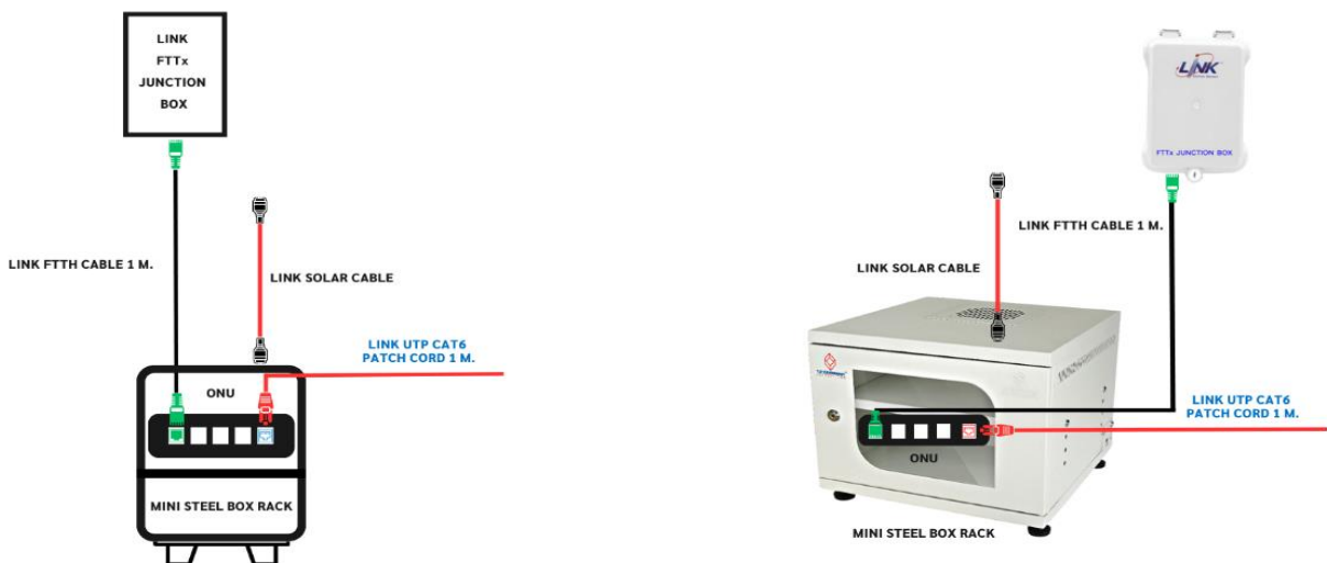
รูปที่ 2 และ 3 การเชื่อมต่ออุปกรณ์จาก OPEN CABLING BOARD ไป MINI STEEL BOX RACK
